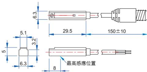
DTE-Z73 出線型與端子型 / 外型尺寸
